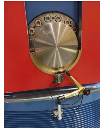
Abb.3 Überprüfung auf bleibende Verformung nach der Belastungsprüfung
